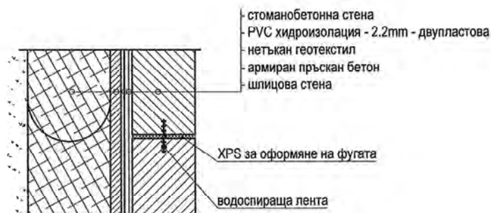
Дилатационна фуга стоманобетонна стена
